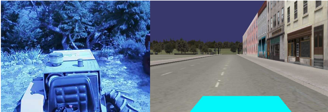
Rys 2. Po lewej widok z rzeczywistej kamery maszyny LOCOSTRA. Po prawej widok z kamery symulowanej w środowisku VORTEX.
